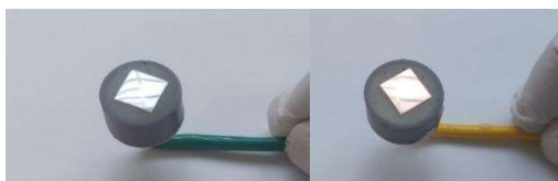
Hình 1. Các điện cực làm việc bằng thép CT3 và đồng M1
