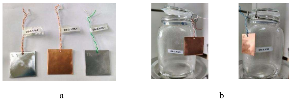
Hình 2. Mẫu kim loại thử nghiệm mù muối và nhiệt ẩm (a) và bình thủy tinh có nắp cài kín (b) trong thử nghiệm nhiệt ẩm
