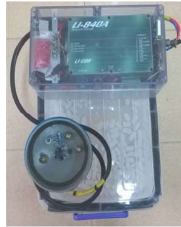
Hình 3. Tổ hợp máy đo hô hấp đất với máy phân tích khí LI-840A
