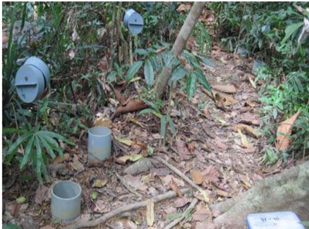
Hình 2. Các buồng kín của phép đo hô hấp đất (pha tối)
